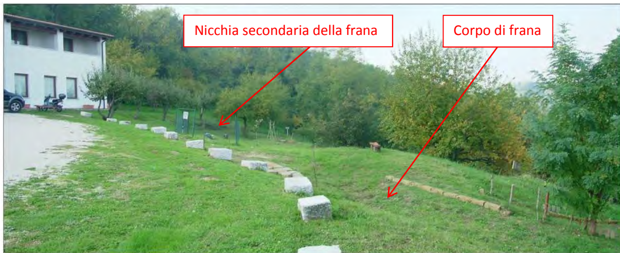
Agriturismo in via Zini: nicchia e corpo della frana di scorrimento presente nel cortile de fabbricato
