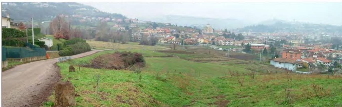
Parte bassa del corpo di frana di colamento in loc. San Bortolo
